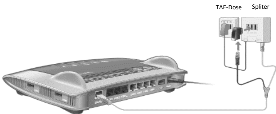
Abbildung 3: Router-Anschluss mit analogem Telefon
